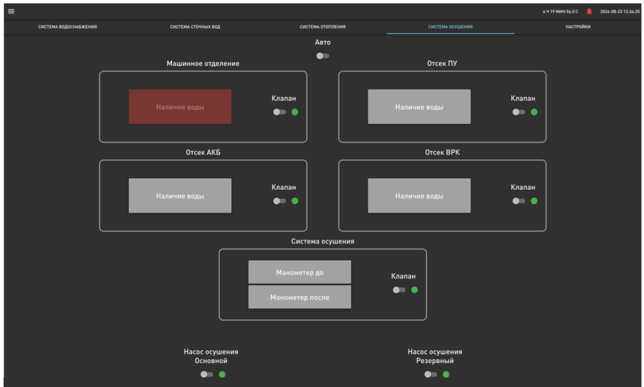
Рисунок 27 - Осушительная система. Детектирование воды в отсеке
