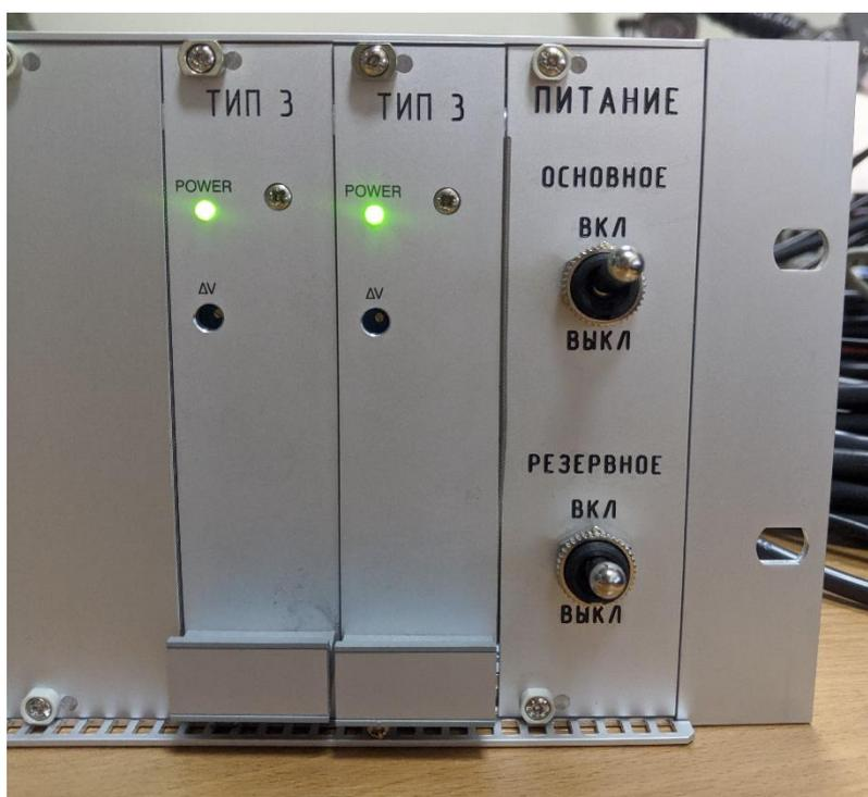
Рисунок 2.1 – Расположение модулей типа 3 и тумблеров подачи питания
