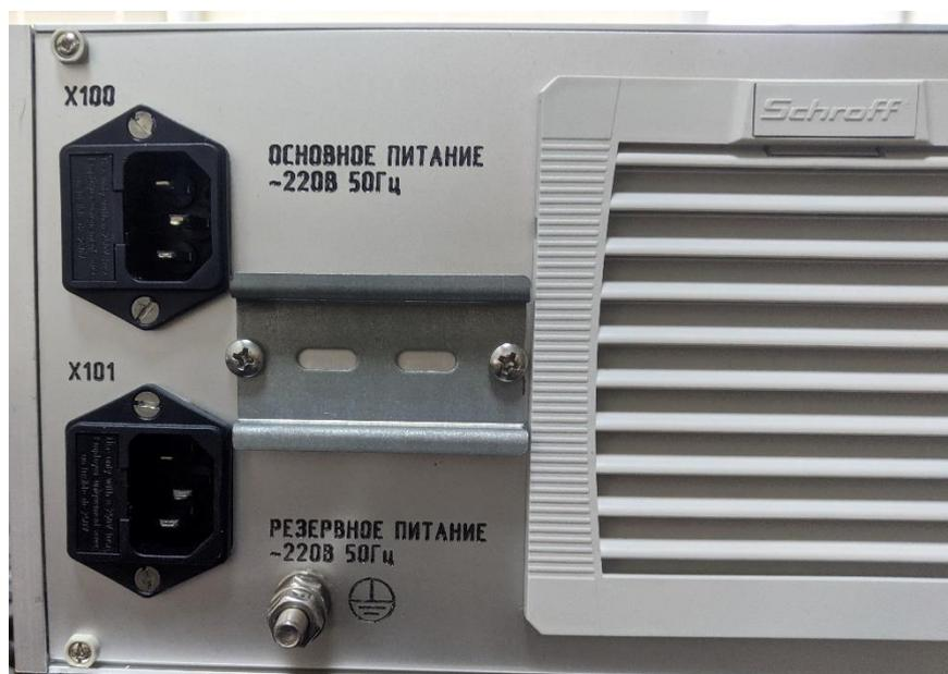
Рисунок 3.2 – Расположение разъёмов X100 и X101 на стойке приборной ККС
