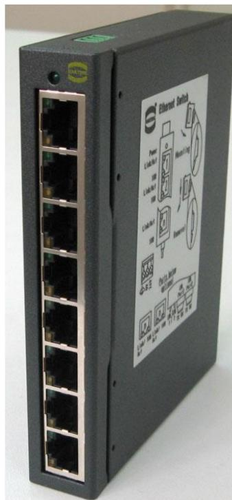
Рисунок 2.4 – Коммутатор сети Ethernet
