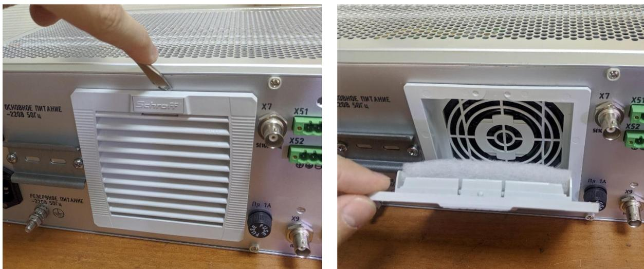
Рисунок 4.1 – Порядок замены фильтра вентиляционной решётки
