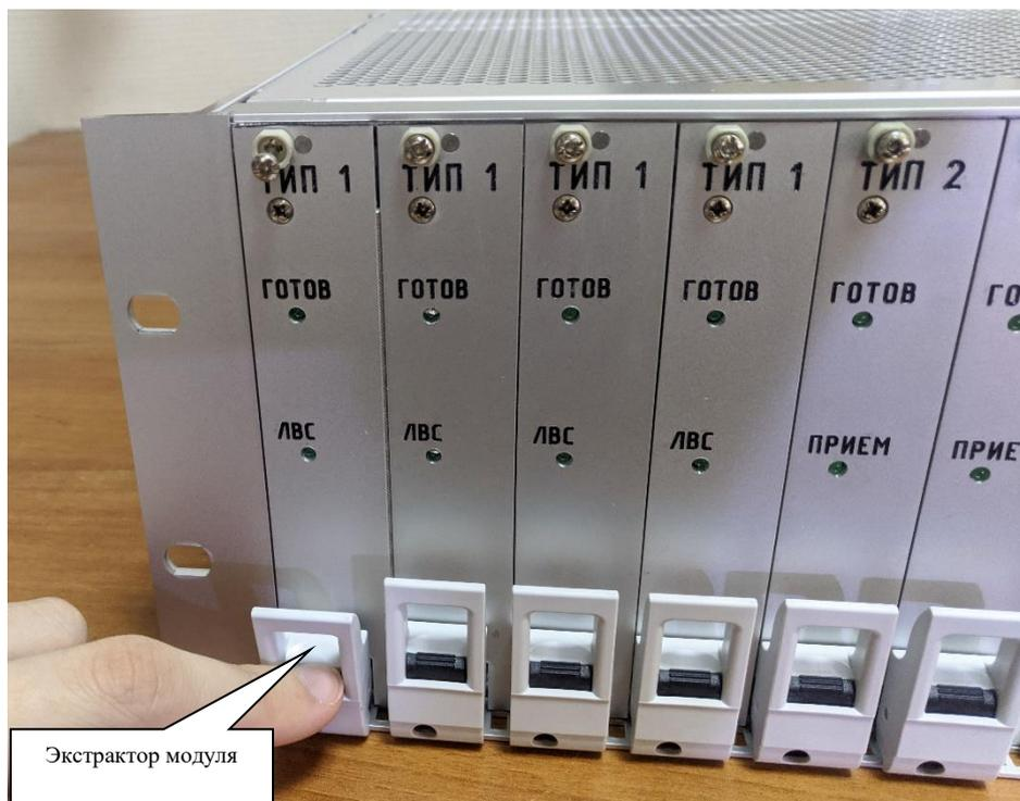
Рисунок 3.3 – Порядок перезапуска модуля типа 1
